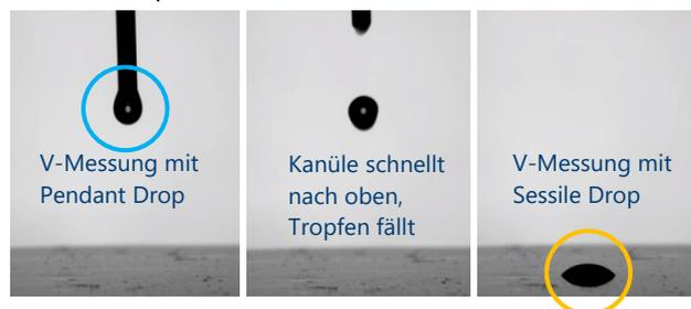
Abb. 2: Versuchsabfolge bei der Volumenüberprüfung
