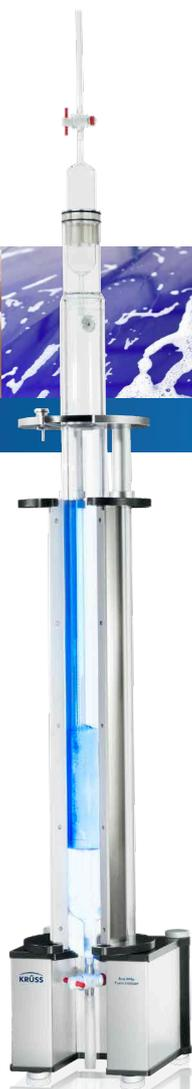
根据ASTM D1173标准全自动
