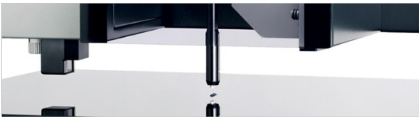
使用可选的液体针头滴定单元, 可快速, 自动地对表面自由能进行样品映射
