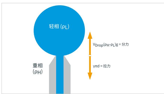
滴体积法张力仪的测量原理
