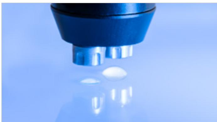
使用液体针头通过两个液滴快速测量表面自由能SFE
