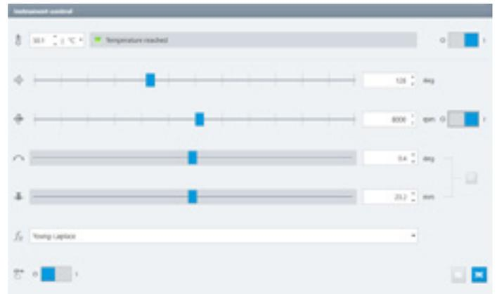
界面张力 (IFT) 测量可精确到非常低的值:借助我们的 SDT 型旋转滴界面张力仪, ADVANCE 可以分析旋转毛细管中液滴的图像,使用液滴的直径或曲率来确定 IFT。
