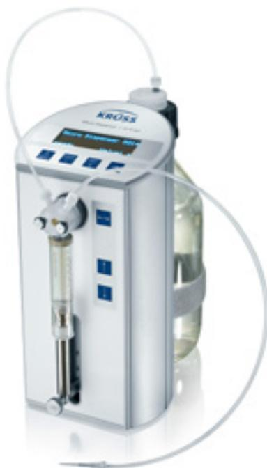
我们专门开发的微型液体分配器专门配备了于力学法表面张力仪Tensió,可使用一或两个分配器单元(DS1110 和 DS1120)以最高精度测量临界胶束浓度(CMC)。设置表面活性剂浓度范围,然后全自动进行测量。
