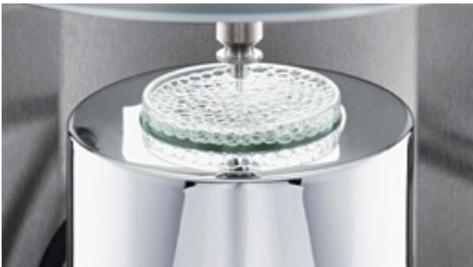
带有集成温控装置的样品台
