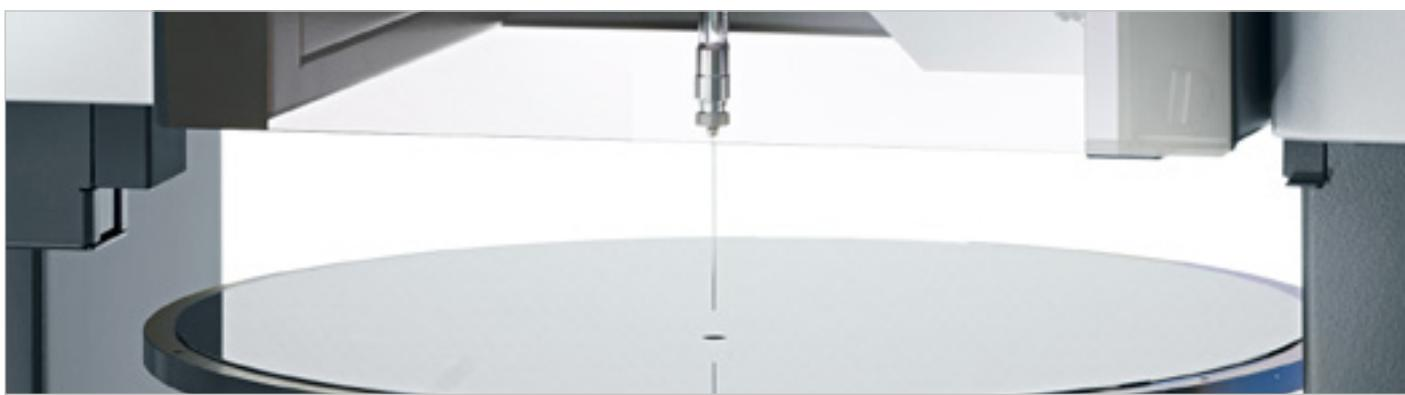
晶片上的全自动液滴定位
