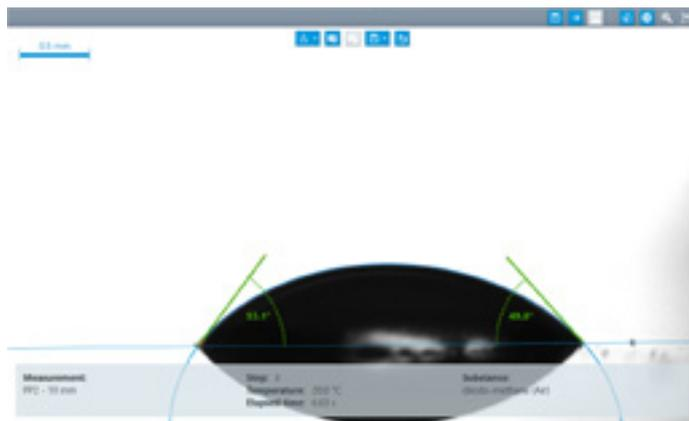
只需单击一下即可测量表面自由能 (SFE)：使用我们的液体针头滴定单元，ADVANCE 同时显示和分析两种滴定的液滴。
