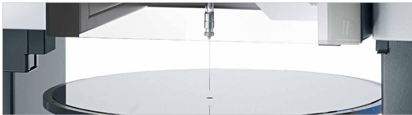
晶片上的全自动液滴定位
