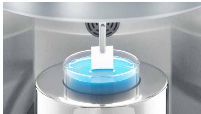
使用润湿力测量固体动态接触角
