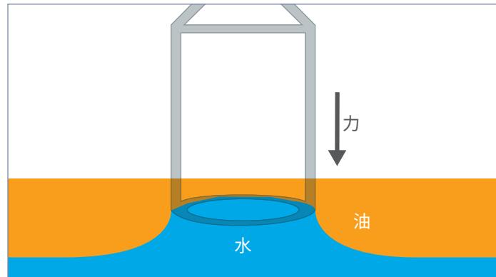
ASTM D 971 和 IEC 62961: 测量绝缘油的界面张力
