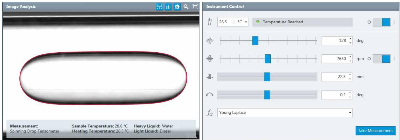
界面张力(IFT)测量可精确到非常低的值:借助我们的SDT型旋转滴界面张力仪,ADVANCE可以分析旋转毛细管中液滴的图像,使用液滴的直径或曲率来确定IFT。
