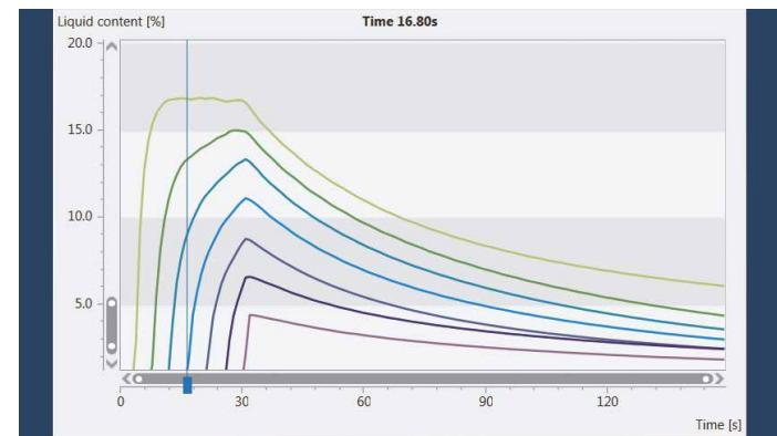
在七个高度位置测量泡沫样品随时间变化的含液量
