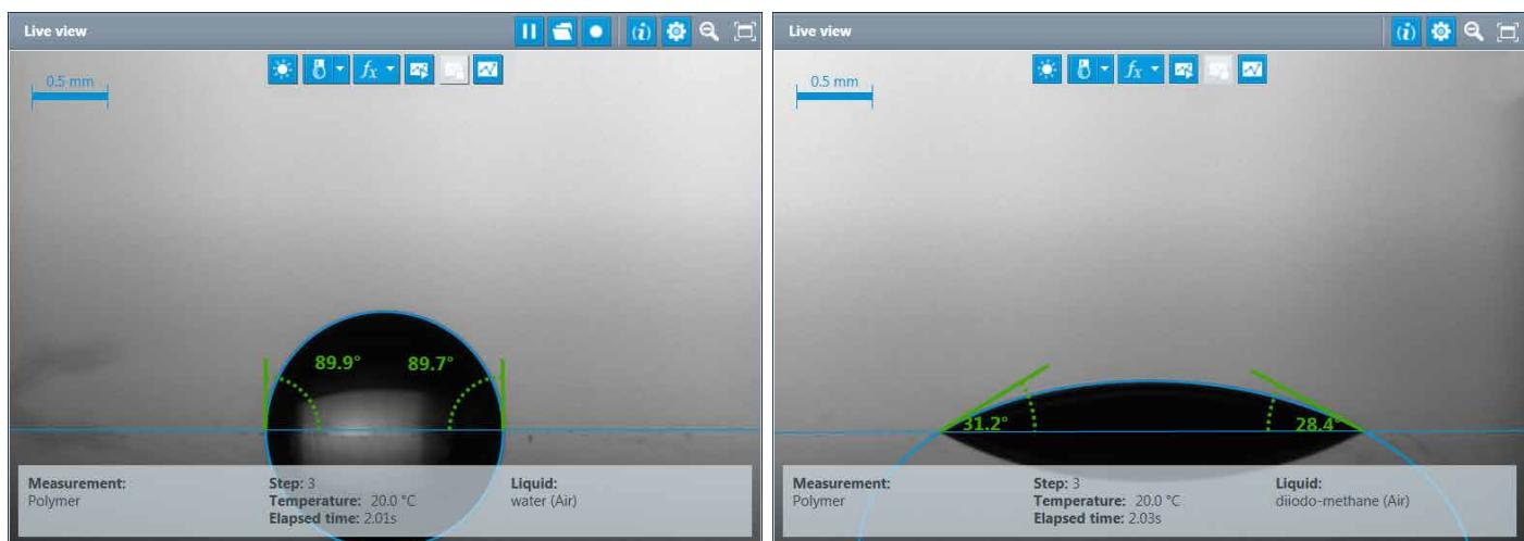
只需单击一下即可测量表面自由能(SFE)：使用我们的液体针头滴定单元，ADVANCE 同时显示和分析两种滴定的液滴。
