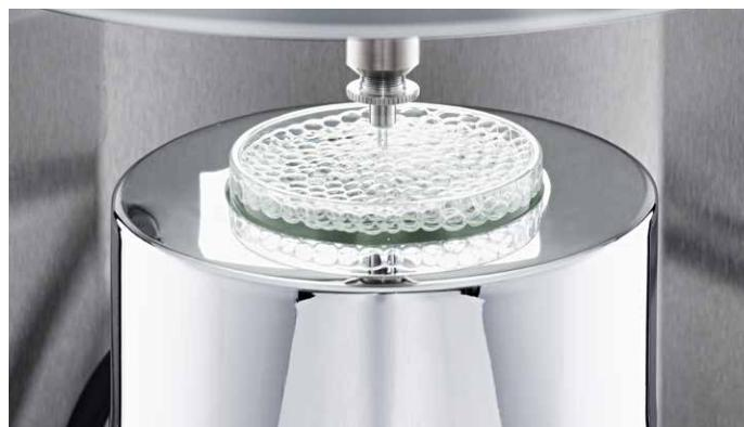
带有集成温控装置的样品台
