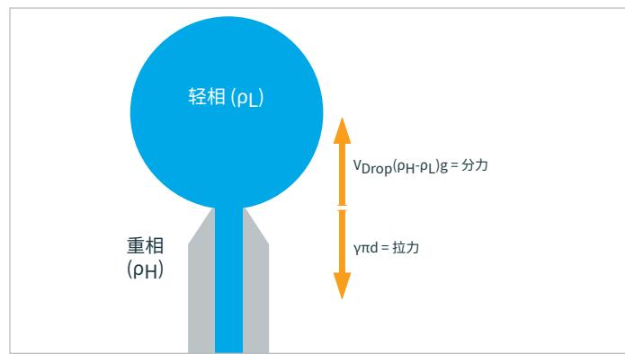
滴体积法张力仪的测量原理
