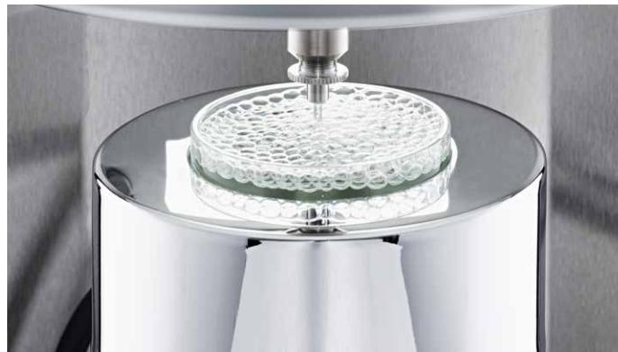
带有集成温控装置的样品台
