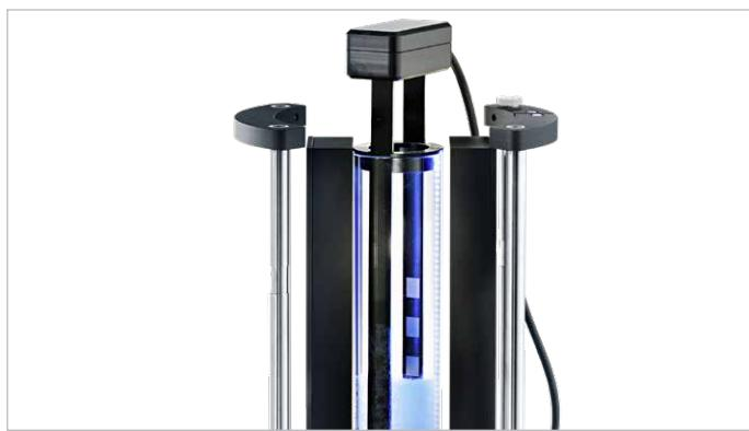
用于分析含液量的电导率传感器
