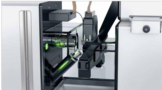
精密的光学系统对液滴和喷嘴进行成像
