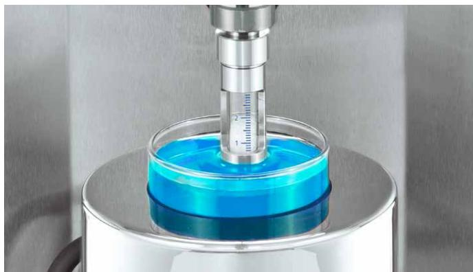
使用 Washburn 法测量粉末接触角
