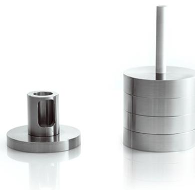
图 2: 带填充重量的 Washburn 吸附元件和制备套件
