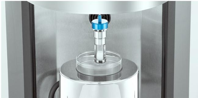
图 4: 含有压缩粉末样品的 Washburn 元件与压力传感器相连
