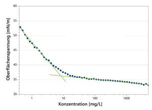
Abb. 2: OFS als Funktion der Konzentration für wässrige Lösungen von PG-10-1-O. Aus der linearen Extrapolation resultiert eine kritische Konzentration der Selbstorganisation zwischen 8 und 11 mg/L.
