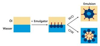
Abb. 1: Schematische Darstellung der Bildung von W/O- und O/W-Emulsionen
