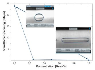
Abb. 3: GFS zwischen Wasser und verschiedenen PG-10-1-O -Lösungen in CCTG. Die Bilder zeigen exemplarisch rotierende Tropfen der Ölphase in Wasser.
