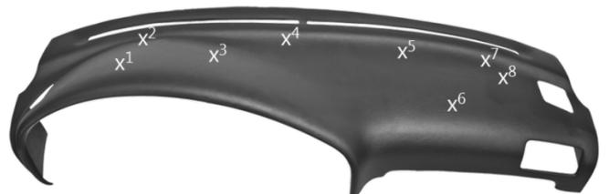
Abb. 3: Schematische Darstellung einer Armaturenabdeckungsprobe. Messungen wurden je an acht Stellen durchgeführt, welche hier entsprechend markiert sind.
