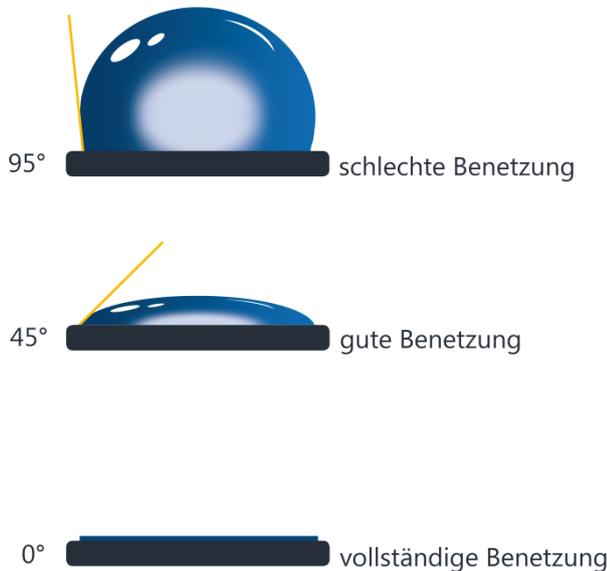
Abb. 2: Zusammenhang zwischen Kontaktwinkel und Benetzung
