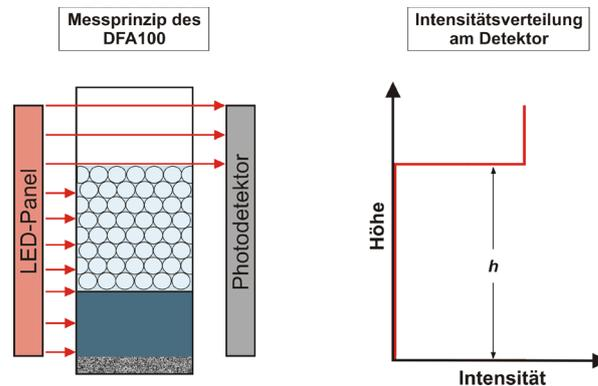
Abb. 2: Höhendetektion beim DFA100 bei intransparenter Flüssigkeit
