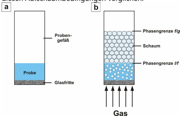
Abb. 1: Aufschäumen durch Luftstrom mit dem DFA100
