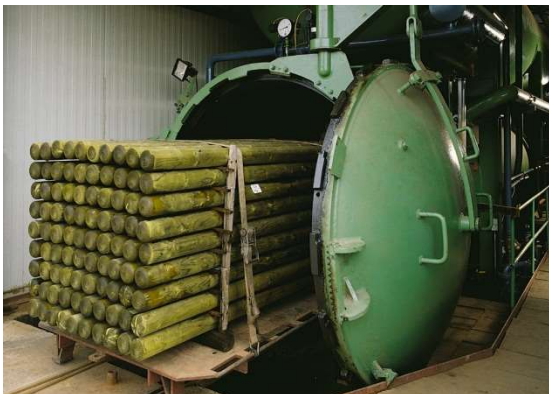
Behandeltes Holz verlässt einen Druckkessel (Bild: Dr. Wolman GmbH)
