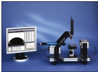
KRÜSS Kontaktwinkel-Messgerät EasyDrop
