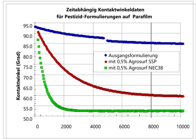
Jede der Proben bildet mit Parafilm® einen Anfangskontaktwinkel um 90° aus. Der Wert für die ursprüngliche Formulierung reduziert sich nur auf etwa 86°. Die Probe mit 0,5% Agrosurf SSP erreicht einen Gleichgewichtskontaktwinkel von 61°, die mit 0,5% Agrosurf NEC38 geht auf 54° zurück und erreicht den Endwert schneller.
