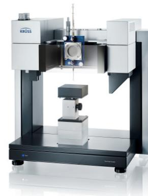
Abb. 4: Verantwortlich für die Tropfendehnung: Das EDM/ODM-Modul
