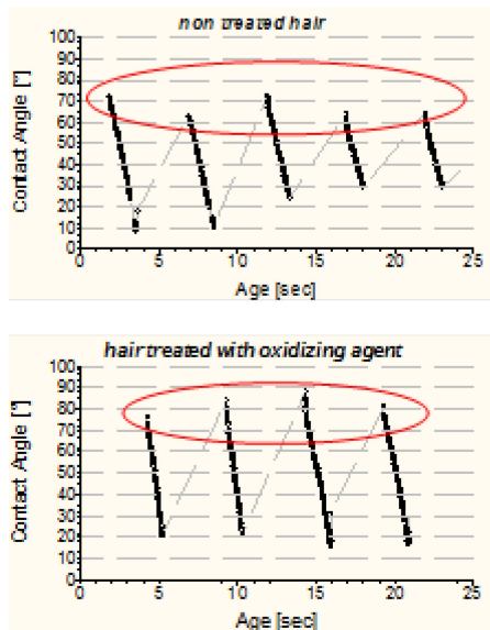
Abb. 5: Kontaktwinkelmessdaten von fünf ca. 100 pl großen Wassertropfen aufgebracht im Abstand von 5 s, auf einem unbehandelten Haar (oben) und von vier ca. 100 pl großen Wassertropfen auf einem mit Oxidationsmitteln behandelten Haar in Abhängigkeit der kompletten Messzeit. Die Aufnahmegeschwindigkeit der Kamera war auf 250 fps eingestellt.
