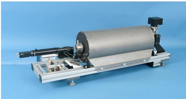
Abb. 1: KRÜSS Tropfenkonturanalyse-System DSA10HT
