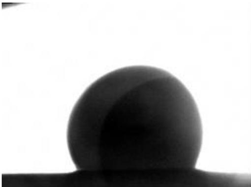
Abb. 5: Schlackeprobe auf Graphit bei ca. 1635°C
