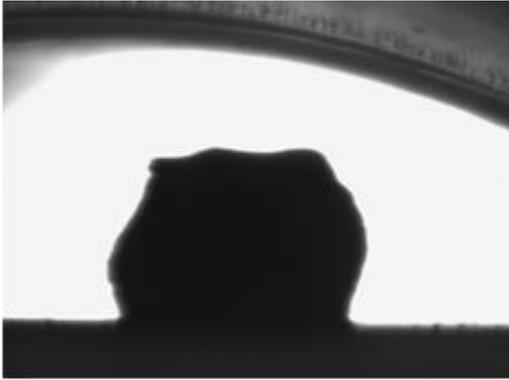
Abb. 10: Schlacke auf  $\text{Al}_2\text{O}_3$  bei ca. 1365°C
