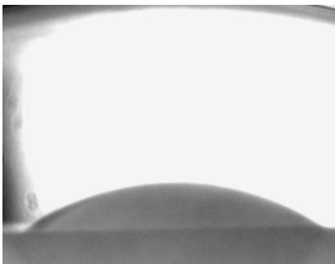
Abb. 7: Geschmolzene Schlacke auf Graphit bei ca. 1700°C
