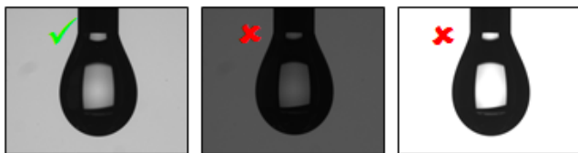
Abb. 7: Tropfenbild mit geeigneter (A), zu dunkler (B) und zu heller (C) Hintergrundbeleuchtung.
