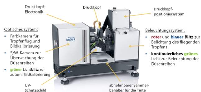
Abb. 1: Aufbau des DSA Inkjet mit montiertem Druckkopf
