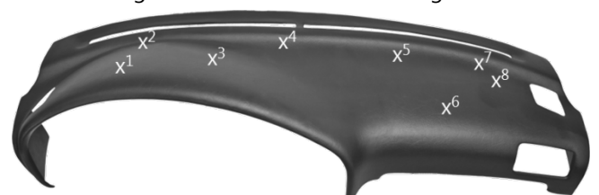
Abb. 3: Schematische Darstellung einer Armaturenabdeckungsprobe. Messungen wurden je an acht Stellen durchgeführt, welche hier entsprechend markiert sind.
