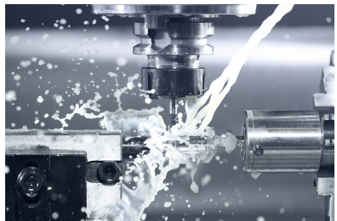
Abb. 1: Kühlschmiermittel im Einsatz: Schaum unerwünscht
