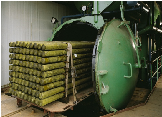
Behandeltes Holz verlässt einen Druckkessel (Bild: Dr. Wolman GmbH)
