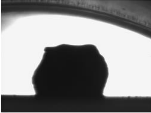
Abb. 10: Schlacke auf \text{Al}_2\text{O}_3 bei ca. 1365°C
