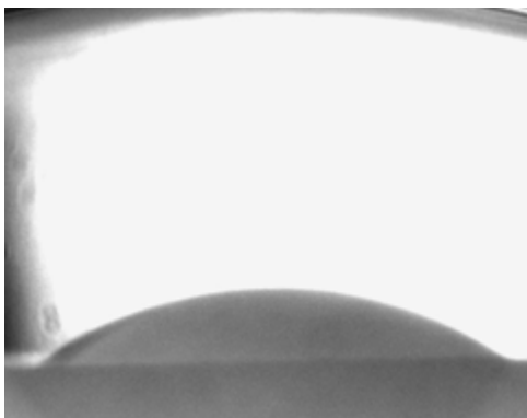
Abb. 7: Geschmolzene Schlacke auf Graphit bei ca. 1700°C
