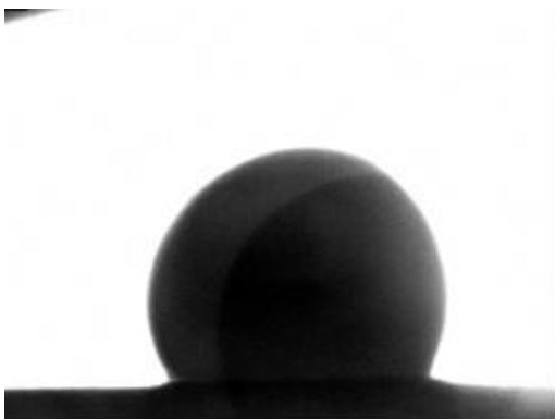
Abb. 5: Schlackeprobe auf Graphit bei ca. 1635°C
