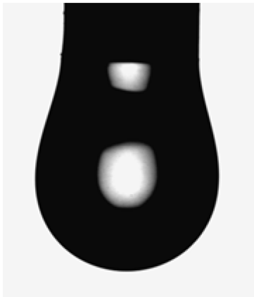
Abb. 2: Videoaufnahme des hängenden Tropfens, Probe U, 110°C
